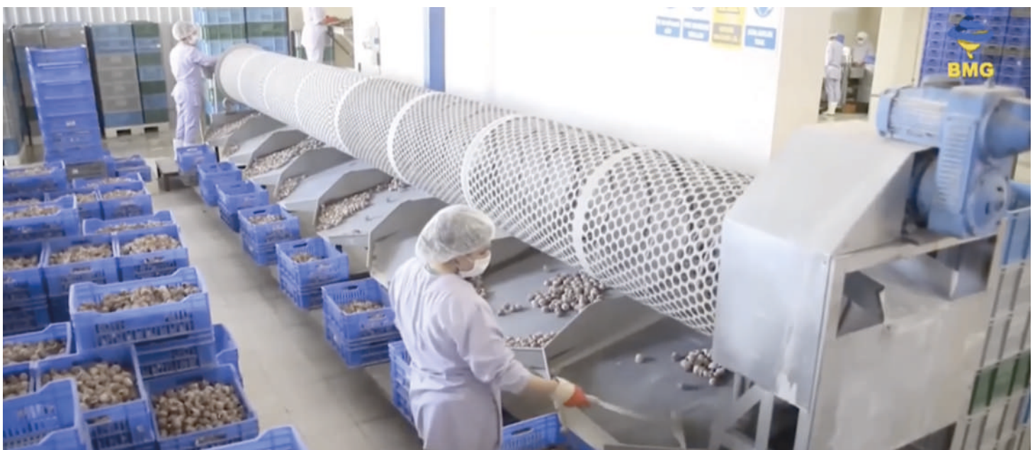
Zona di inizio del ciclo di lavorazione nello stabilimento, con la preventiva calibratura automatica dei gusci
